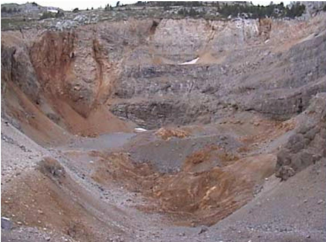
Figure 4. Carrière de bauxite à ciel ouvert, dans la zone de Karkanirachi, près de notre camp de base (dimensions : environ 100 m de haut, et 300 m de diamètre).
